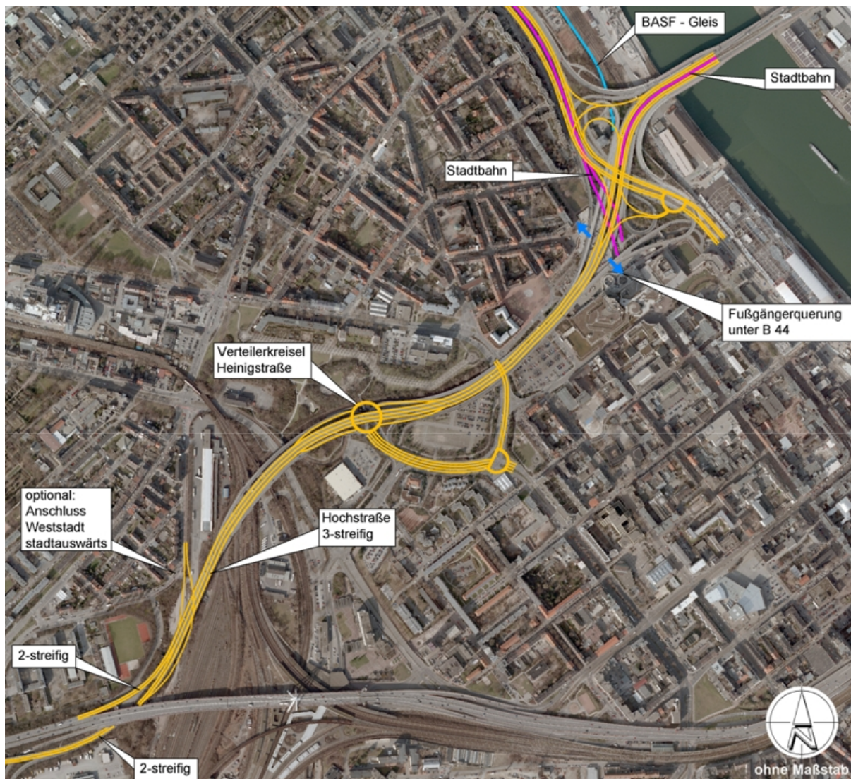
Abb. 11: Variante 1 – Neubau 3-streifige Hochstraße 29
