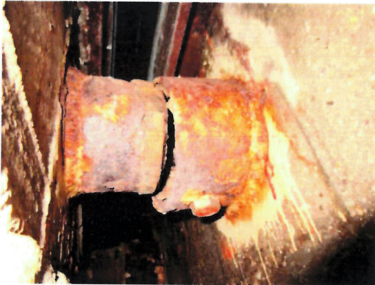
167-0_LAG QUERKRAFTKOPPLUNG IST GETRENNT
